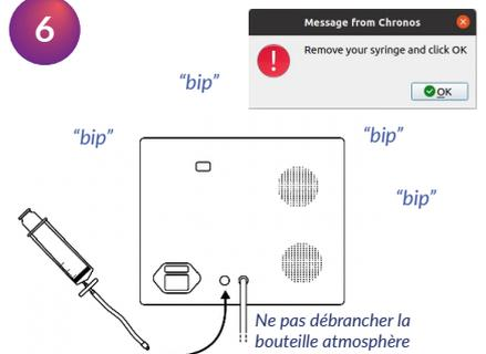
Retirer le tuyau 2 du port extérieur de Chronos Dx en appuyant sur la pièce métallique et cliquer sur OK.
