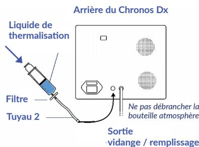
Appuyer sur le piston de la seringue pour remplir Chronos Dx jusqu'à ce qu'il émette des bips sonores.
