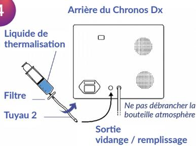
Raccorder la seringue au filtre et au tuyau 2 et à la sortie vidage remplissage Chronos Dx.
