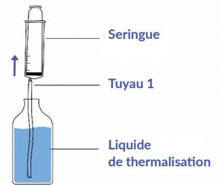
Connecter la seringue au tuyau 1 puis la remplir avec le liquide de thermalisation.
